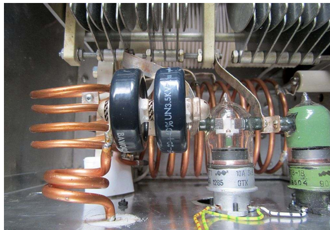
Pifilterspolarna. Notera förlängningsspolen för 1,8 MHz av teflonkoax som skymtar bakom vridkondensatorn C1.
