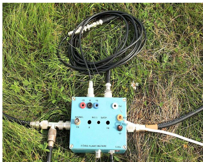
En återanvänd aluminiumlåda försågs i förväg med några SO239-kontakter och användes för reläerna. Man ser fasningskoaxen överst i bild, matningen till höger och vänster antenn samt sladden (vit) för manöverspänning (12 V) av reläerna. Lådan låg normalt insvept i en plastkasse för att skyddas mot regn. Reläerna var av enkel växlande sort från Biltema.
