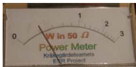
Transceivern med lågeffekt vid 13.5V, ca 200mW.
