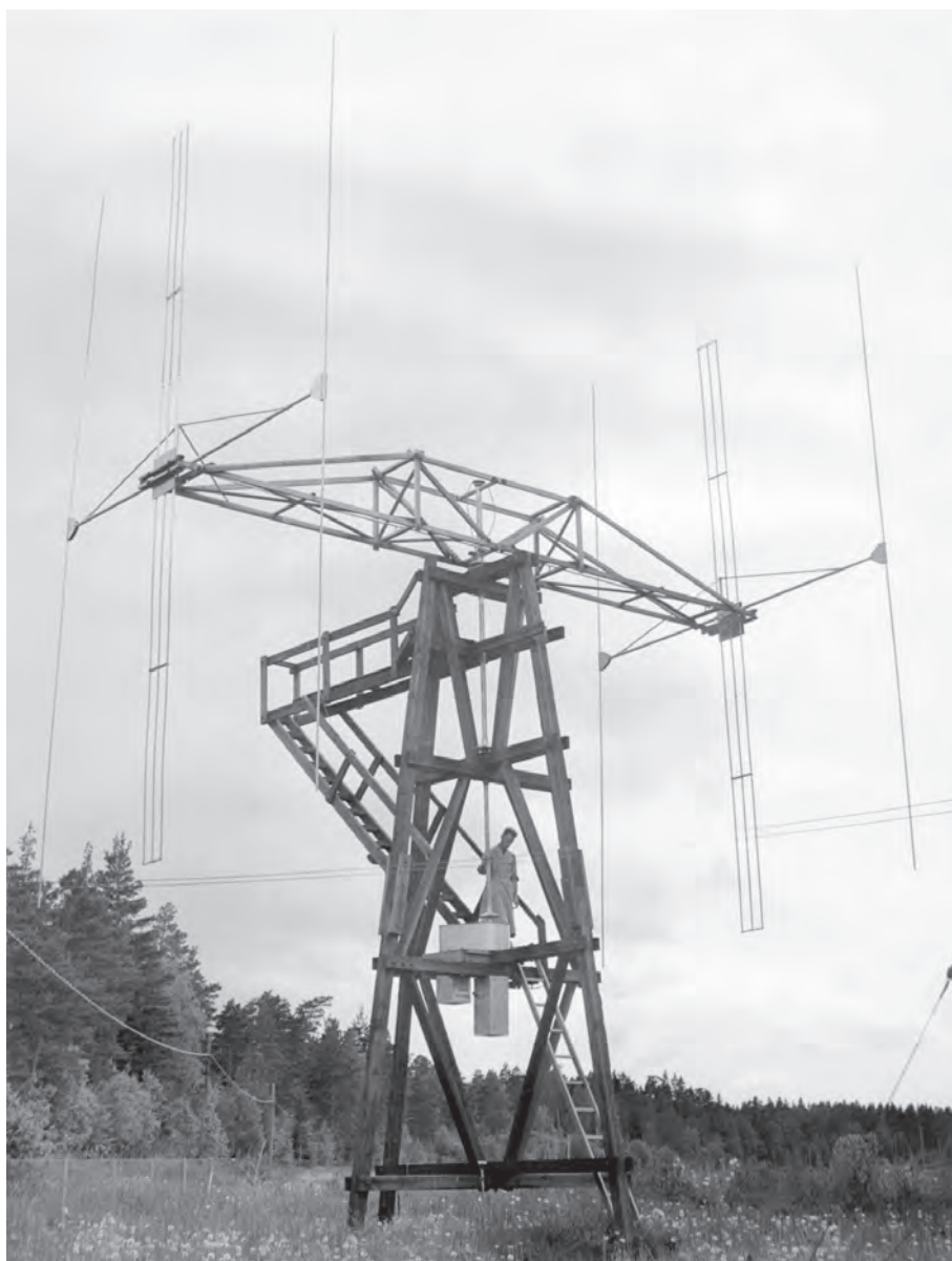
2×3 element vertikal för backscatter för 19,5 MHz.
