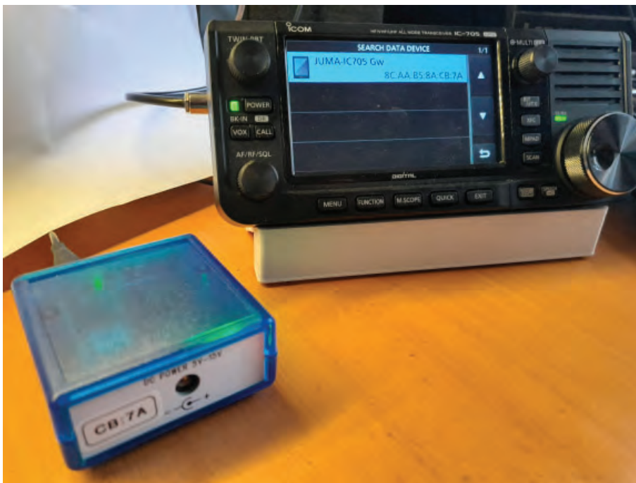
BILD 6: Vill man koppla in en Icom IC-705 så måste vi använda ett blå-tandsinterface. Se i radions display hur det har identifierat sig, redo att skicka kommandon till PA:t.
