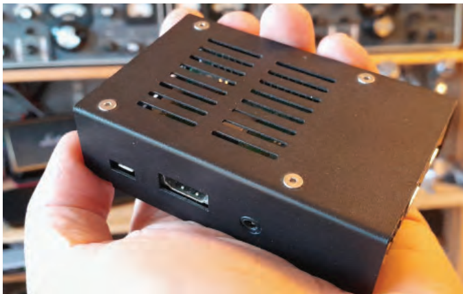
BILD 4: En Raspberry Pi är allt som behövs för att kunna sätta upp en node-red-server. Man kan köra i Windows, Mac OS och Linux också för den som vill.
