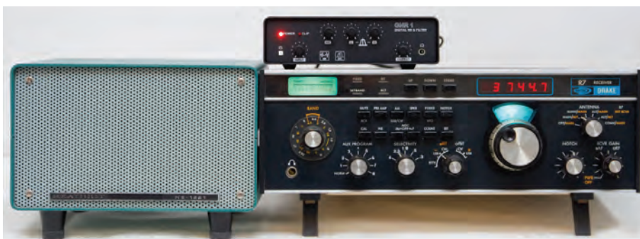
BILD 3: Så här kan det se ut när man kopplar in en gammal trotjänare i form av en Drake R7 till XIEGU GNR1. Som framgår av bilden får en Heathkit-högtalare leverera förstärkt och filtrerad signal, en elegant kombination.
