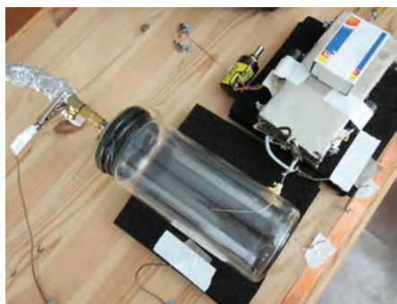
BILD 30: Glasburk (olivburk) med 3 cm antenn. Förstärkare med offset-potentiometer. Det svarta materialet är elektriskt ledande skum.
