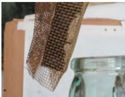
BILD 3: Fläkt och dess vinkel mot flaskhalsen. Typ: Multicomp MC35357, "borstlös". Nät för avskärmning av elektriska fält.
