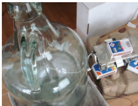
BILD 2: Helmoltz flaskan, ~5 liter. En 10 cm antennenpinne inuti är E-fältsonden. Till höger en Hemgjord "Giga-ohm" förstärkare.
