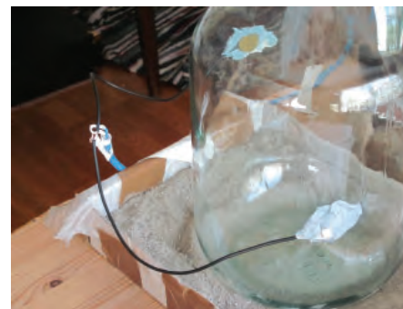
BILD 4: Piezoelektriska pickupmikrofoner Shadow SH712 för ljudmätt.
