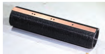
FIGUR 10: Skärmformare med kopparlaminat på undersidan för jordning.
