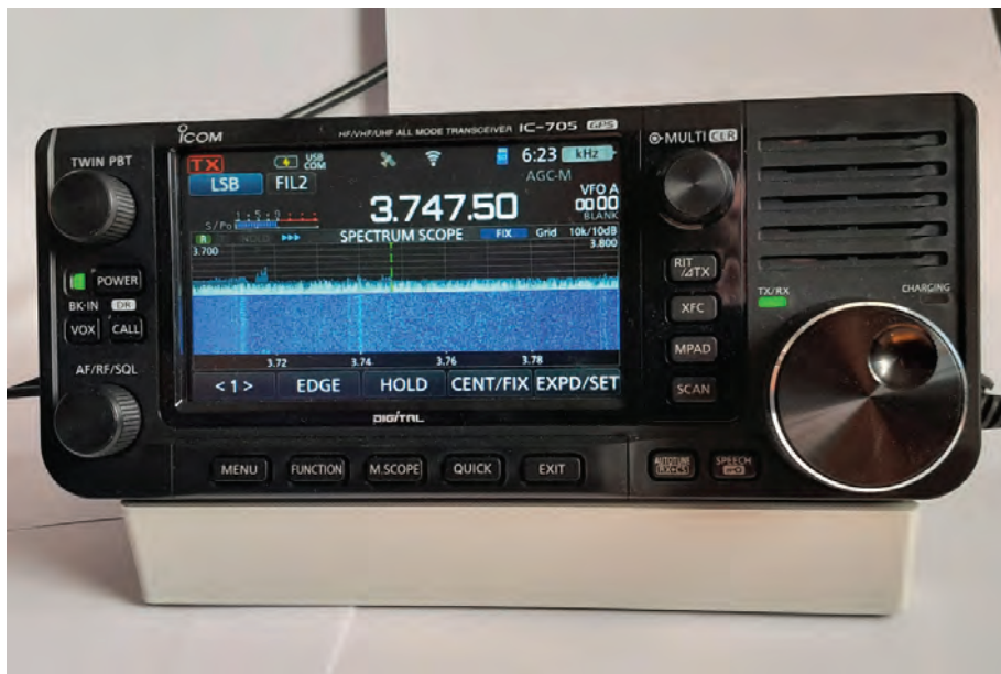
BILD 1: Så här ser den lilla IC-705 ut rakt framifrån. Displayen är den samma som på IC-7300 och mäter 11 cm på diagonalen.
