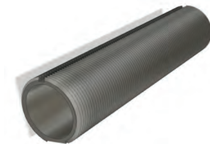
FIGUR 9: 3D-modell av "skärmformaren". De runtgående spåren är spiralformade, som en gänga.
