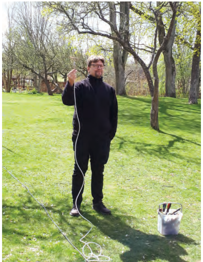
BILD 4: Mätning av Boxkite4X för 23 cm under Field Day i Motala 2022-05-07, entusiast med okänd signal håller upp mät-sändarens (brusgeneratorns) dipolantenn på lagom höjd och avstånd från mätobjektet.
