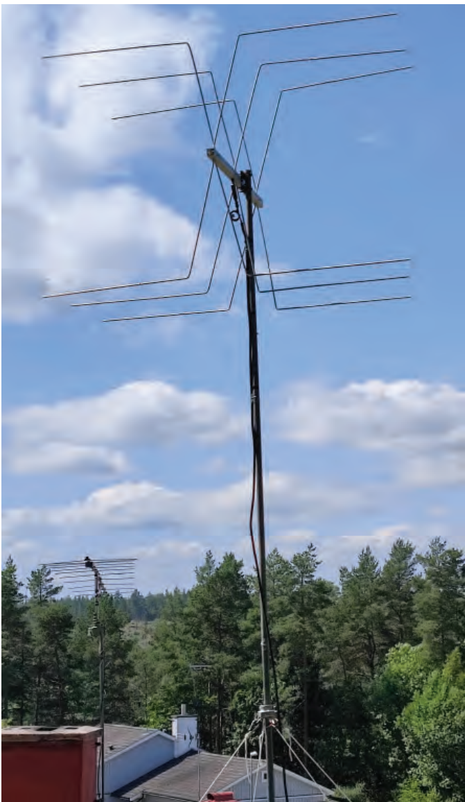
BILD 5: Boxkite3 för 6 och 2 m med utsikt från skogsbacken i Valdemarsvik. I bakgrunden på skorstenen 11 element långyagi för 2 m med bomlängd 6 m.
