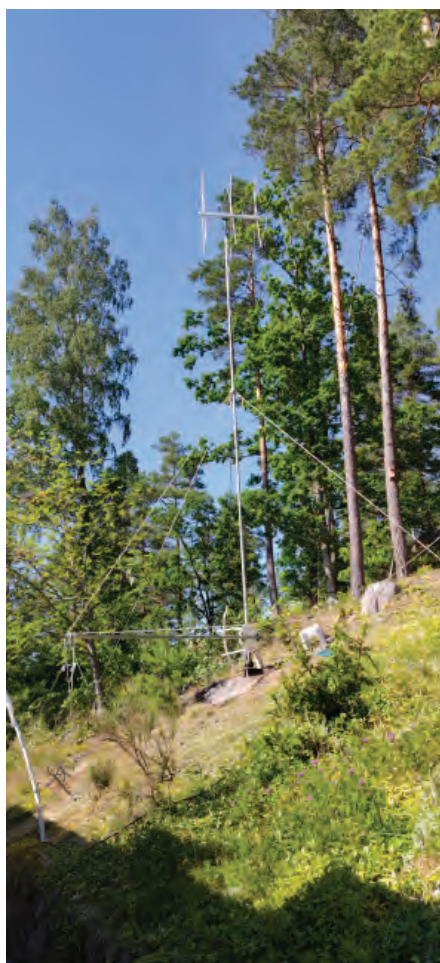
BILD 6: Annan vy av Boxkite3 för 6 och 2 m, där den vridbara masten 7 m hög också visas.
