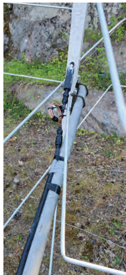
BILD 7A: Närbild av elementens placering på träbommen.
