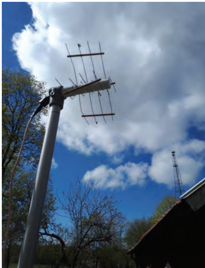
BILD 1: Min ”låddrake” för 23 cm har 4 element och cirka 10 cm bomlängd. Hyfsad överensstämmelse mellan kalkyler och mätningar av riktverkan (t.ex. F/B > 24 dB).
