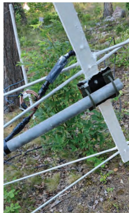
BILD 7B: Detalj av koaxiell anslutning till Boxkite3 via baluner.
