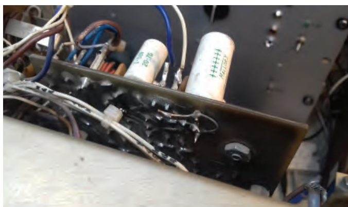
BILD 4: Hemgjorda ledningsbanor på brunnet kretskort som ska kontrolleras och förbättras.
