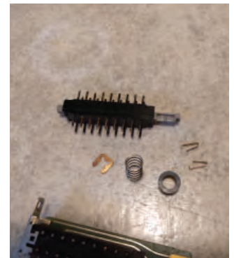
BILD 8: SPOT-omkopplarens inkråm ersätts med delar från en annan omkopplare.
