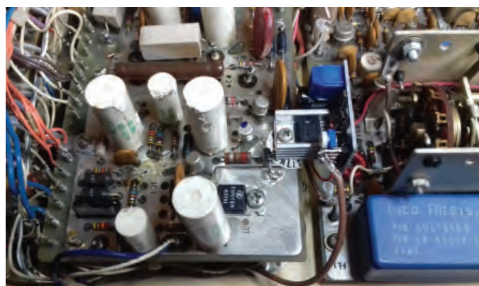
BILD 5: En ny LF-modul med brun sladd som ersätter originalet IC1 på kretskortet.
