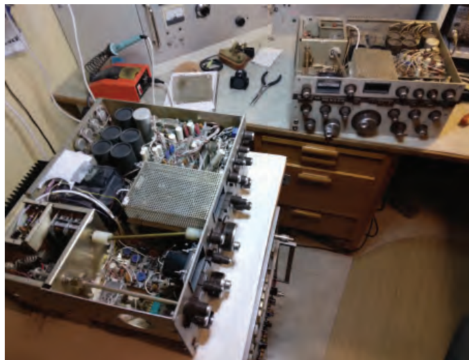
BILD 12: Felsökning i PA-modulen underlättas med en fungerande CX7 som referens.
