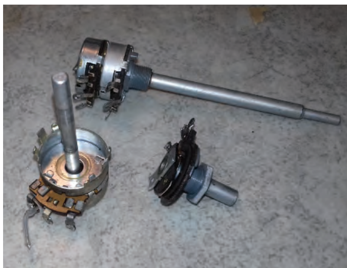
BILD 9: Med surplusdelar från SKOQO byggs nya kolbanor upp i AF/RF-potentiometern.
