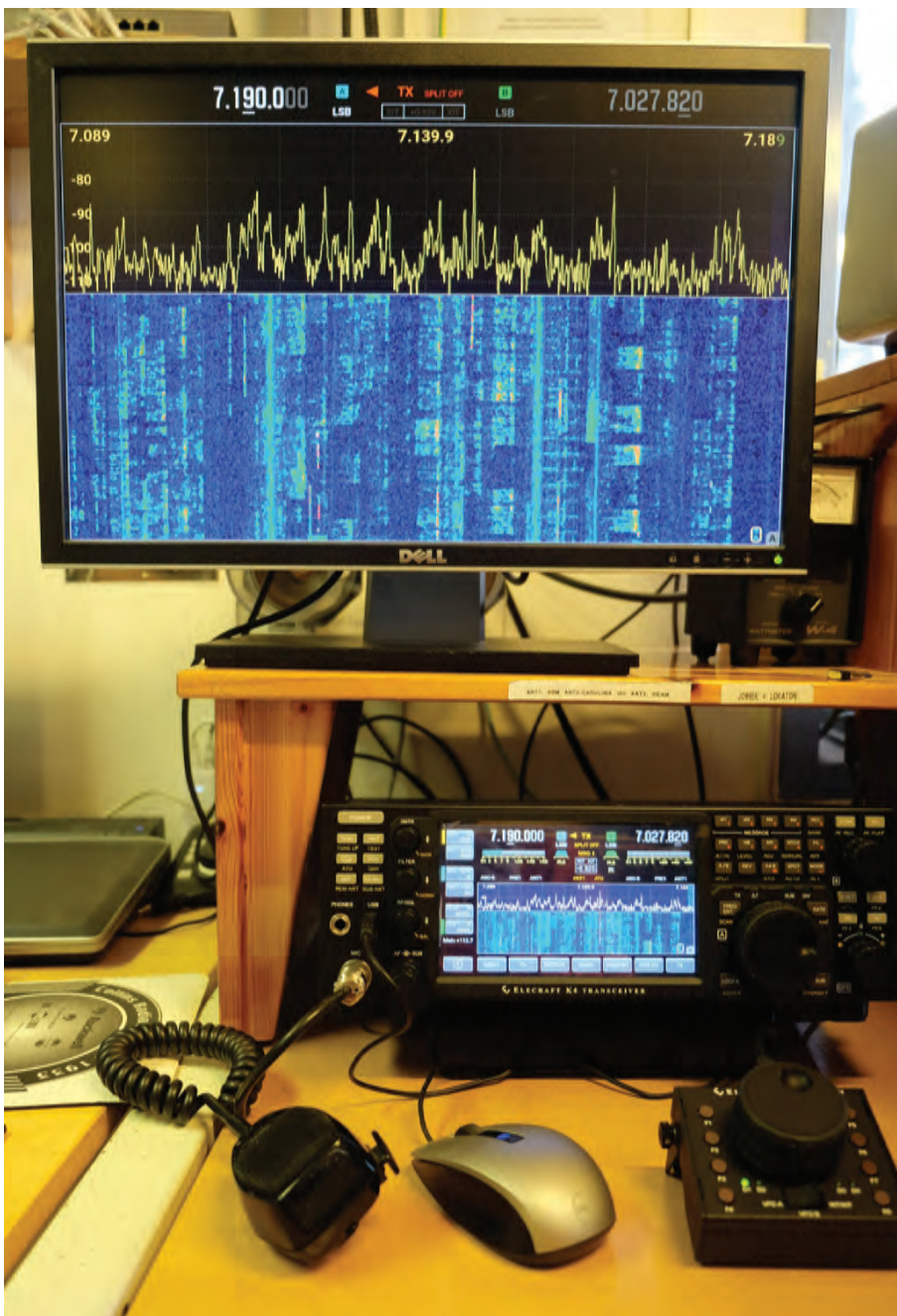
BILD 2: Här skiljer sig Elecraft sig rejält från konkurrenterna när man kopplar in en extern skärm. Informationen på den externa skärmen är inte bara en kopia av radiens. Här kan den externa skärmen äntligen göra nytta.
