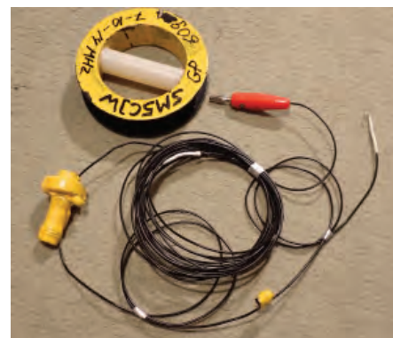
BILD 4: Antenntrådens detaljer samt dess bobin. Det vita VP-röret, som är fastlimmat i bobinen, har ett ingångshål från bobinen som bananpluggen kan stoppas i innan antennen lindas upp. Plaströret, med trap (toroidkärna + kondensator) fastlimmad på, har en innerdiameter som passar för metspöet. Den korta lilla rörstumpen fäster antenntlinan mot metspöet. Antenntlinan avslutas med en Z-krökt metalltråd som passar i metspöets toppögla.
