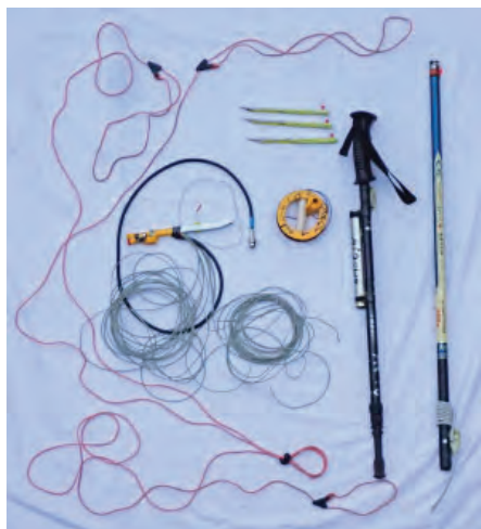
BILD 3: Antennens olika delar. Vandrarstaven, med sin rörformade hållare för metspöet, stagas från under handtaget med de tre staglinorna som fästs i marken med tältpinnarna. Jordplanet är fäst på en aluminiumprofil som sticks ner i marken. Metspöet bär upp antenntråden. Segelhållaren är fäst vid metspöet. Antenntråden är upplindad på sin bobin.
