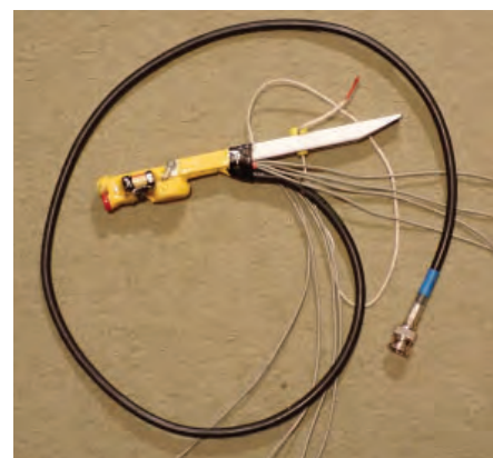
BILD 5: Jordplanets detaljer. De åtta jordplanstrådarna och koaxkabeln är fastsatta och anslutna till aluminiumprofilen. 40 m förlängningsspole och dess lilla latchrelä samt två banankontakter är fastlimmade på aluminiumprofilen. Den vita persiennlinan, med röd ände, används för att hålla ihop ett ihopplindat jordplan vid transport.
