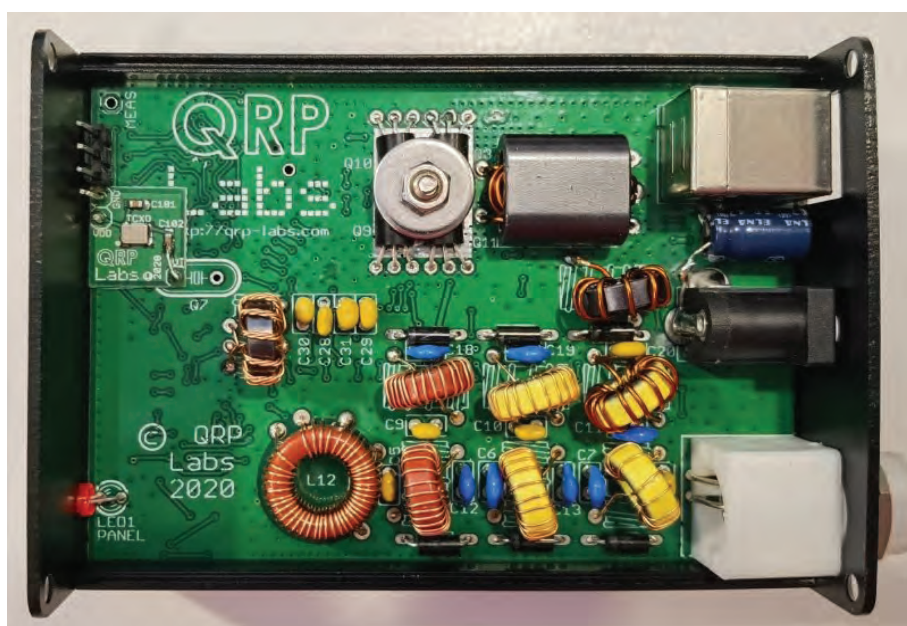
BILD 3: Komponenterna på kretskortets ovansida är de man behöver montera. På undersidan sitter det en hopet ytmonterade komponenter som är fabriksmonterade.
