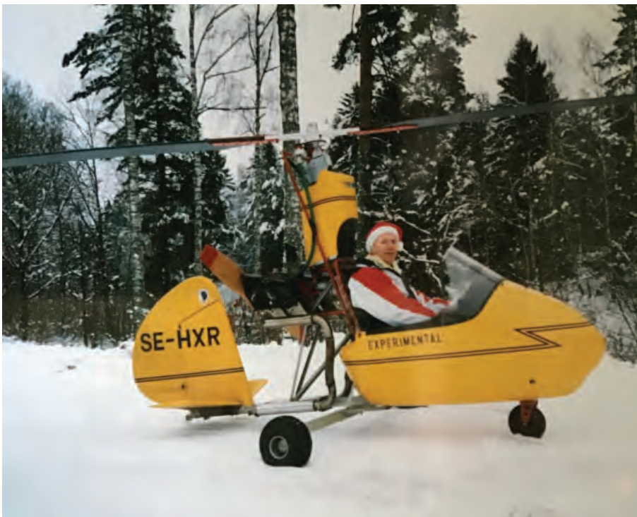
Mitt egenbyggda autogyro (SE-HXR) där alla detaljer tillverkades i garaget. Styrhandtaget är från ett SAAB A32 Lanser, så avtryckaren till raketer blev PTT för flygradion.
