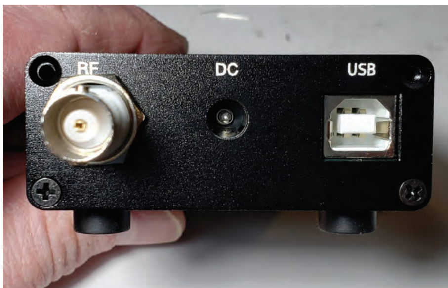
BILD 2: På baksidan kopplar vi in radion till antenn, spänningsmatning (5,5 / 2,1 mm DC-plugg) och USB-snitt till PC:n. Lättare blir det inte.
