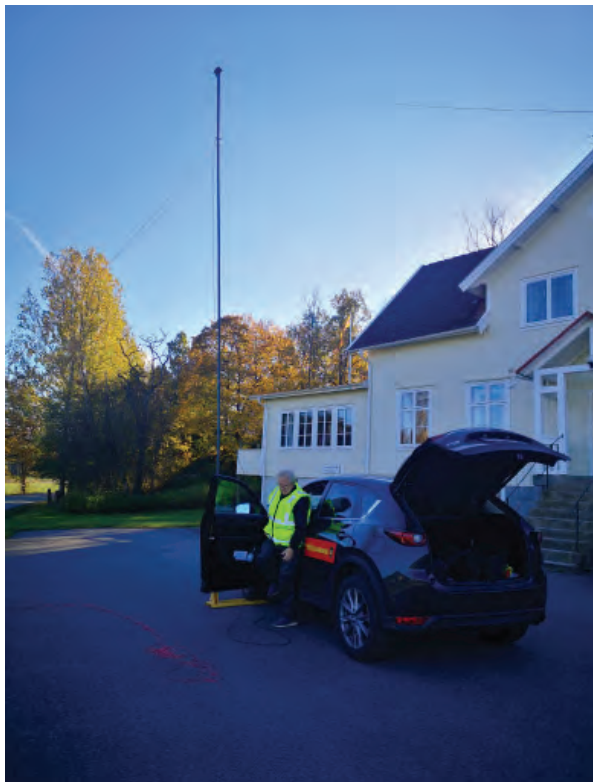
En teleskopmast och ett mastfäste som supportas av hjulet.
