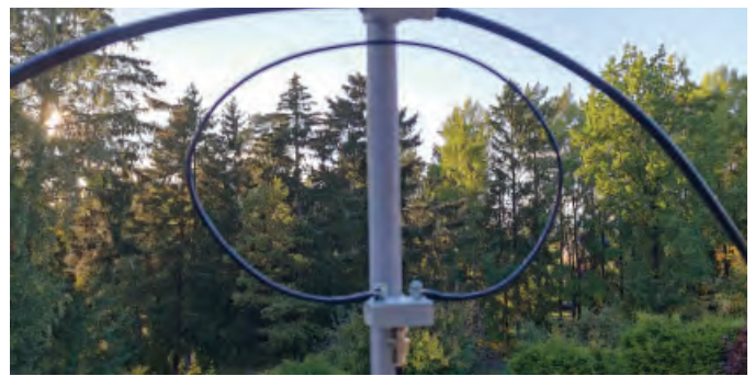
BILD 3 A-B: Att "tweeka" den inre loopen lite kan göra ganska stor skillnad på swr, se texten.
