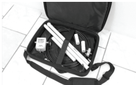
BILD 1: Magnetloopen går att trycka ner i en 17 tums laptopväska.
