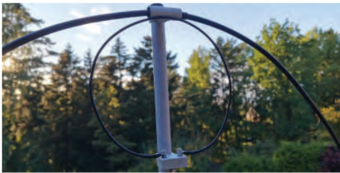
BILD 3 A-B: Att "tweeka" den inre loopen lite kan göra ganska stor skillnad på swr, se texten.
