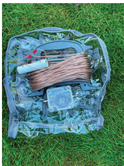
BILD 4: EFHW för 80–10m – "länkad" för 60–30–15m. Mini-1:49 UnUn transformator från HF-Kits i Nederländerna [11]. Förvaringsbag och kabelvinda avsedd för Julens ljusslingor från Clas Ohlson.
