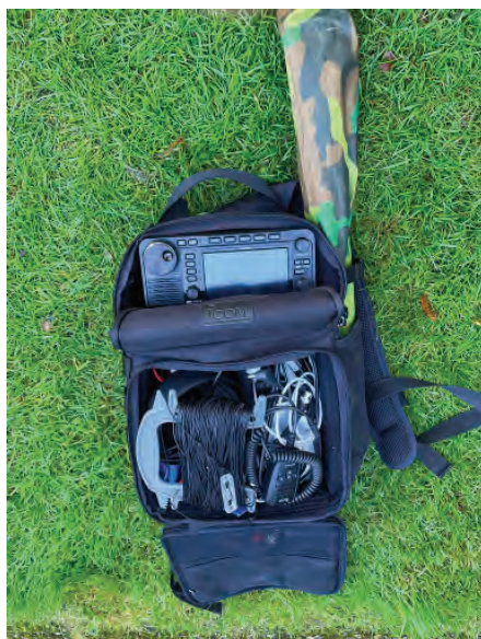
BILD 1: ICOMs ligga ryggsäck för IC705:an. Rymmer allt man behöver för en lyckad portabelutflykt. Det avlånga paketet är en SOTA-beams 6 m teleskopmast som jag oftast använder för att lyfta upp transceiver-ändan av min ändmatade antenn. Den andra änden sitter normalt 15–20 m upp i ett träd.
