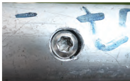
BILD 4: Nersänkt skruv för skarvning av rör som inte passar tajt.
