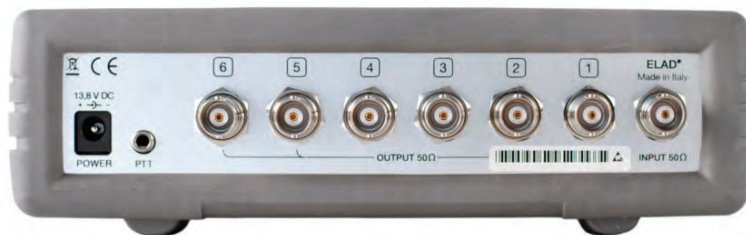
BILD 7: Har man flera mottagare (JZT har fem stycken) som skall kopplas till samma antenn samtidigt behövs en antenndelare. ASA-16 från ELAD gör ett utmärkt jobb.
