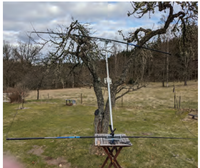
BILD 6: Exempel på trimning av experiment-Moxon-antenn modell "fiskespön" med NanoVNA. Radiator uppåt.
