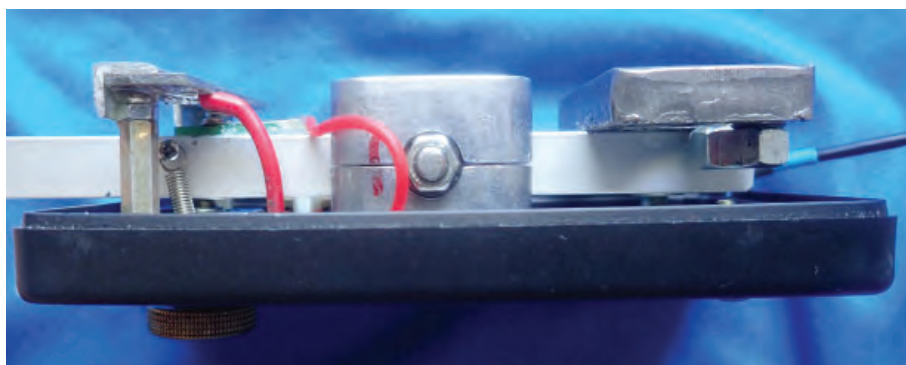
Armen, fjädern, kontakter och kullagerhållaren. Kullagrets diameter är här 10 mm. Muttern på motviktens undersida är en finjustering av balansen.
