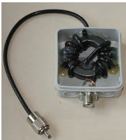
BILD 3: Enkel som princip är W1JR-choken. Linda coax på en ferritring (FT240-43) enligt bilden så spärrar man effektivt HF till skärmen. Kan användas lite här och var i antennsystemet.
