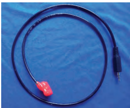
Rödmålad mikrobrytare. Färgen gör att nyckeln lätt hittas när det är min tur att sända eller när utrustningen skall packas.
