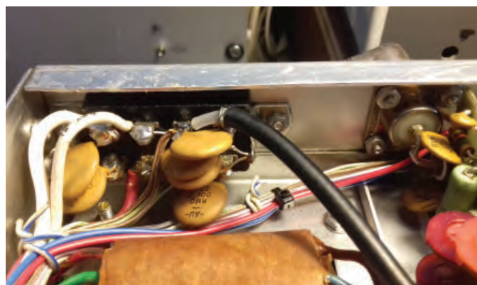
BILD 5: B- från polskrur ansluts till stift 6 på insidan av 8-polig kontakt.
