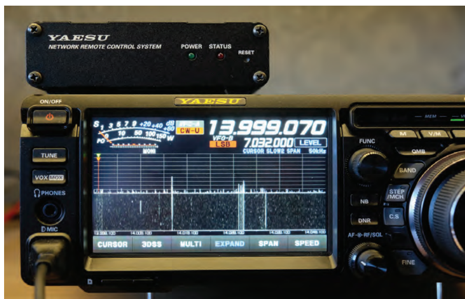
BILD 1: Den lilla lådan på en FTDX-10 är SCU-LAN10.
