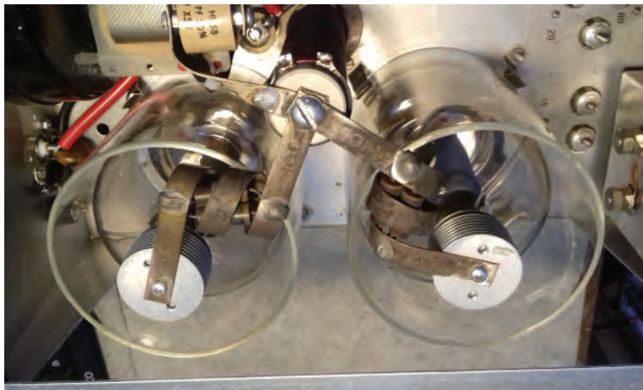
BILD 9: QB-rören med skorstenar av härdat glas avsett för fotogenlampor.
