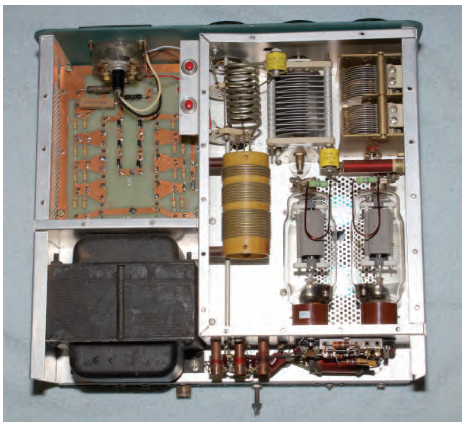
BILD 7: På ovsidan syns slutrören med RF-drosslarna mm.
