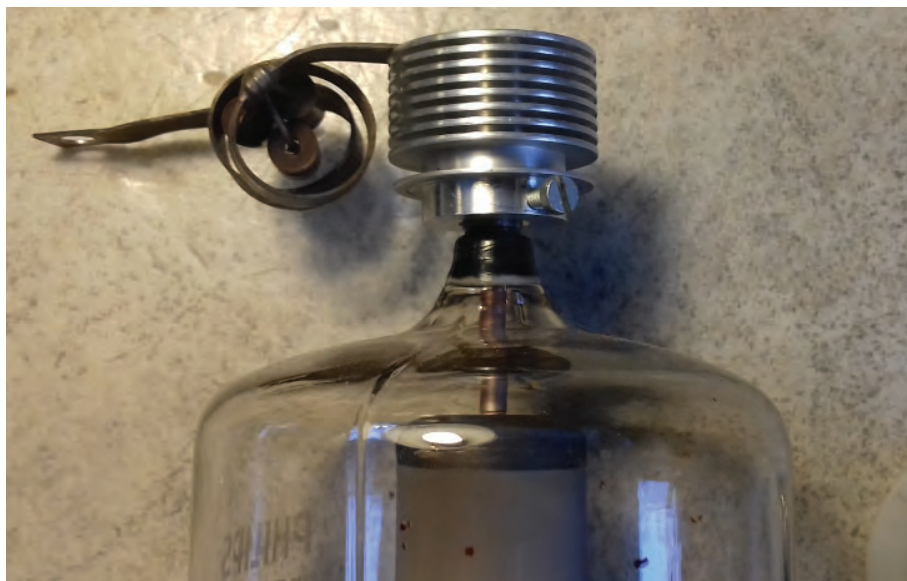
BILD 8: Anodanslutning tillverkad av kylkropp från rör 2C39/7289.
