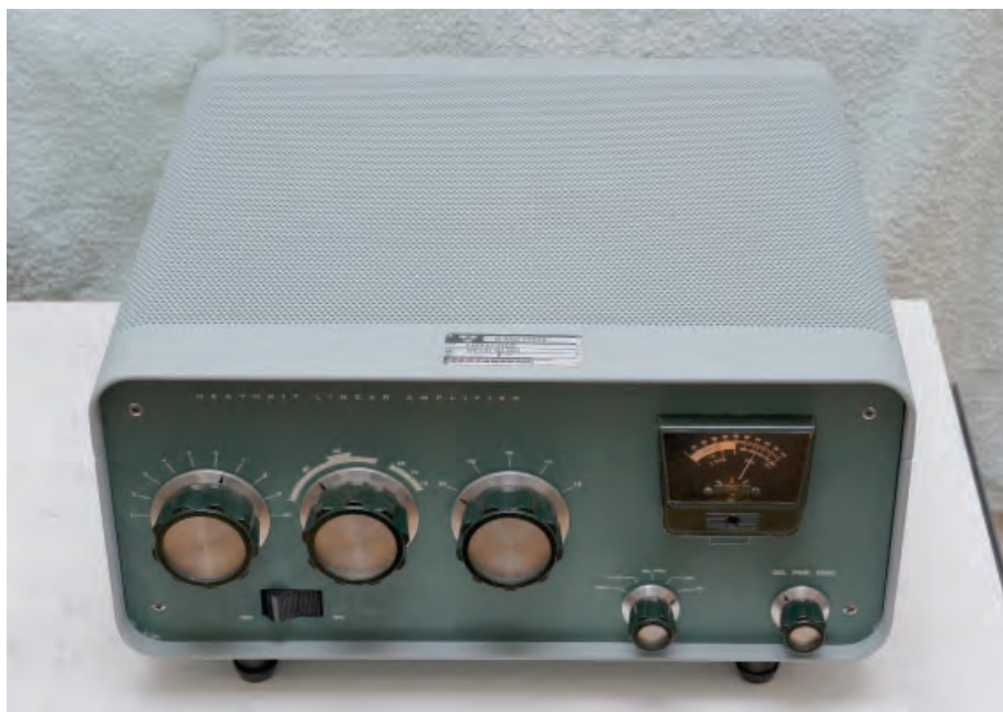
BILD 1: SB-200 nr 2953 renoverad och klar, instrumentet visar spänningen.
