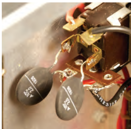
BILD 3: Mjukstart - NTC-motstånd monterade efter huvudströmbrytaren.
