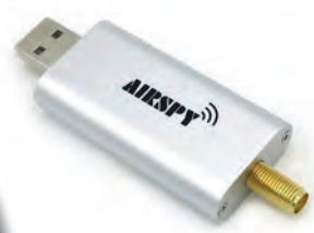
Airspy Mini • 24MHz - 1800MHz kontinuerligt • 3.5 dB NF mellan 42-1002 MHz • 12 bitars ADC
