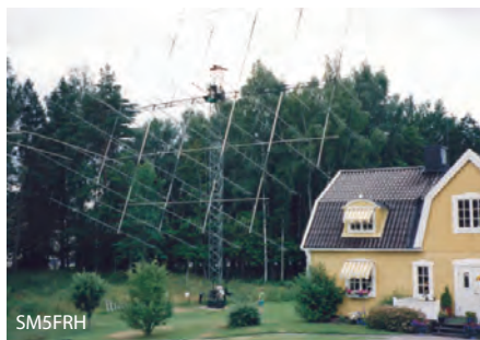
EME-antenn hos SM7BAE, Kjell (SK). 50 MHz 8x9 element Yagi. 144 MHz 8x20 element Yagi. Se QTC 2007 nr 6-7, s.14.
