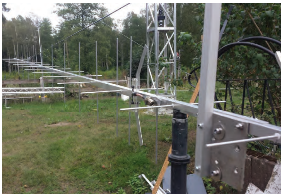
Efter en del laborerande och testande beslutar jag mig för att bygga om alla antenner genom att sätta en 14-elements vertikalt polariserad antenn, återigen av DG7YBN:s design, på samma bom som de 25 elementen, framför all stackningshårdvara som tvärbom och antenninfästning.
