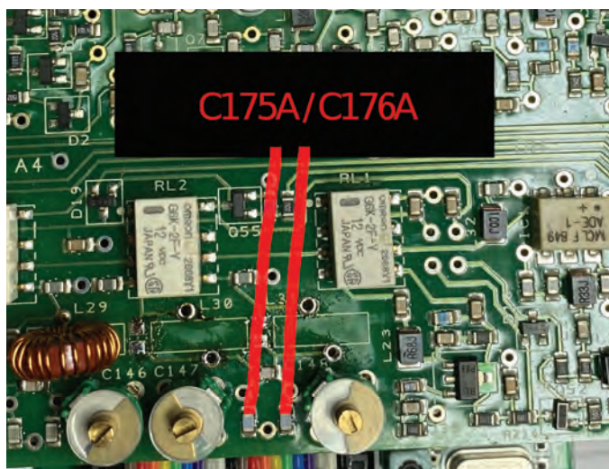
BILD 4: Montera dubbla 22 pF ovanpå respektive C175/C176.
