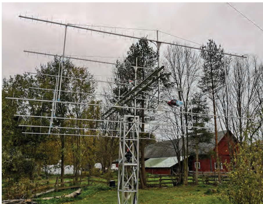
Under sommaren 2018 byggdes antennerna om och samtidigt byggde jag om matningen för 25-elementarna till öppen stege samt sänkte masten för att kunna komma åt matningen från marken.
