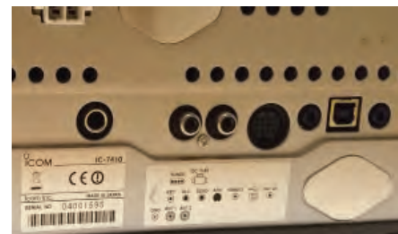
BILD 1: Exempel på tillbehörsuttag "ACC", USB samt "Remote" för CAT-styrning.
