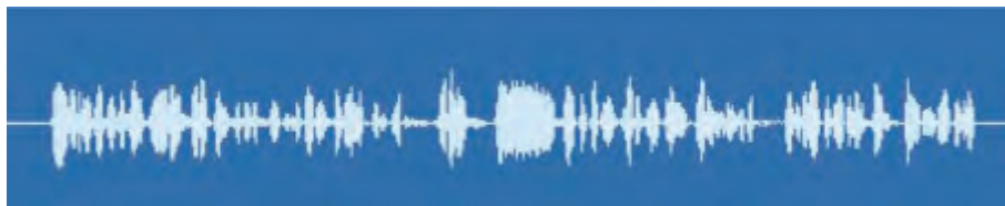
BILD 1: Station med relativt liten skillnad mellan starka och svaga partier = normal dynamik för en kommunikationsradio.
