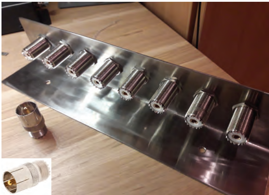
BILD 1: Så här snyggt och enkelt ser en "antennväxel" ut bakifrån. PL-genomföringskontakter har monterats på en skinande blank plåt. På baksidan kopplas radioapparaterna in. Infälld i bilden ses en PL-snabbkopplingsadapter.
