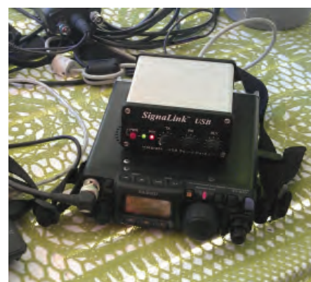
BILD 2: Ett Signalink USB anslutet till en Yeasu FT817 för portabelbruk.
