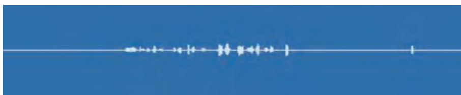
BILD 3: Mycket svagt modulerad signal. Man talar tyst eller långt från mikrofonen.
