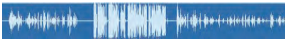
BILD 4: Exempel på QSO mellan två stationer med mycket stor skillnad i dynamik. Här måste man manuellt justera volymkontrollen för att det ska vara behagligt att lyssna på konversationen.
