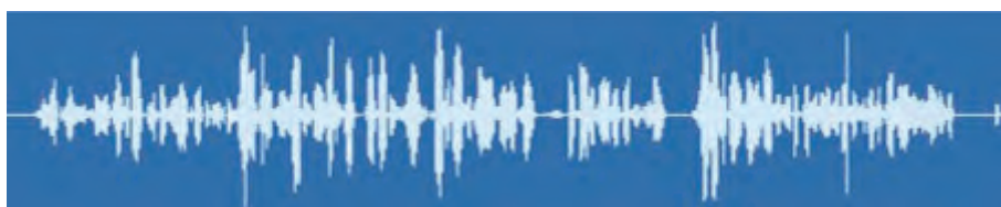
BILD 2: Station med märkbar skillnad mellan stark och svag modulation = hög dynamik.
