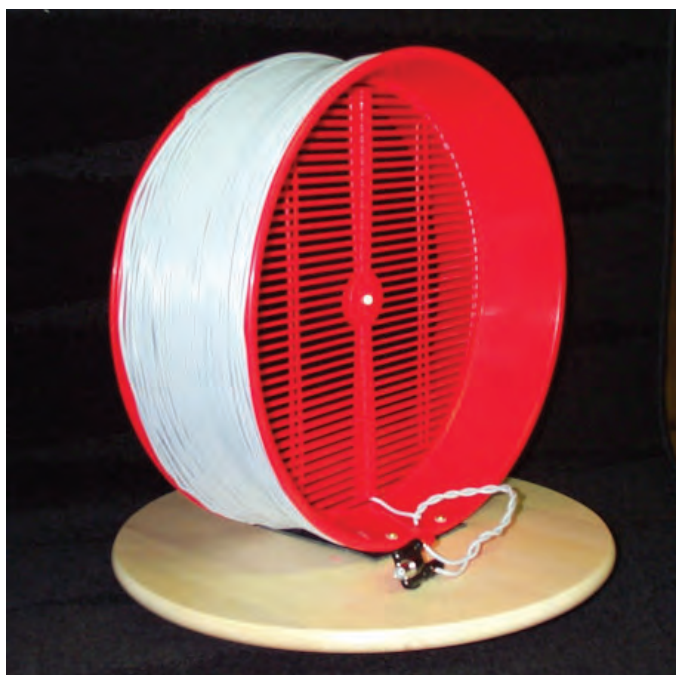
Ramantenn för SAQ, tillverkad av två "Bärrensaren Jonas".
