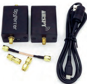
Airspy R2 & SpyVerter R2 RX från DC till 1,8GHz
