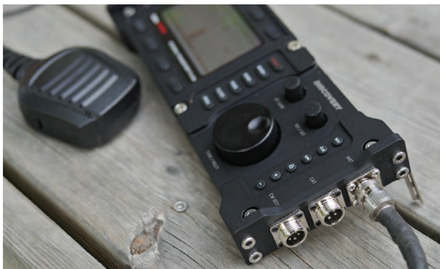
BILD 2: Kontaktdonen på sidorna inger förtroende. Radions bakkant kan "pallas upp" med små infällbara fötter för bättre vinkel mot operatören.
