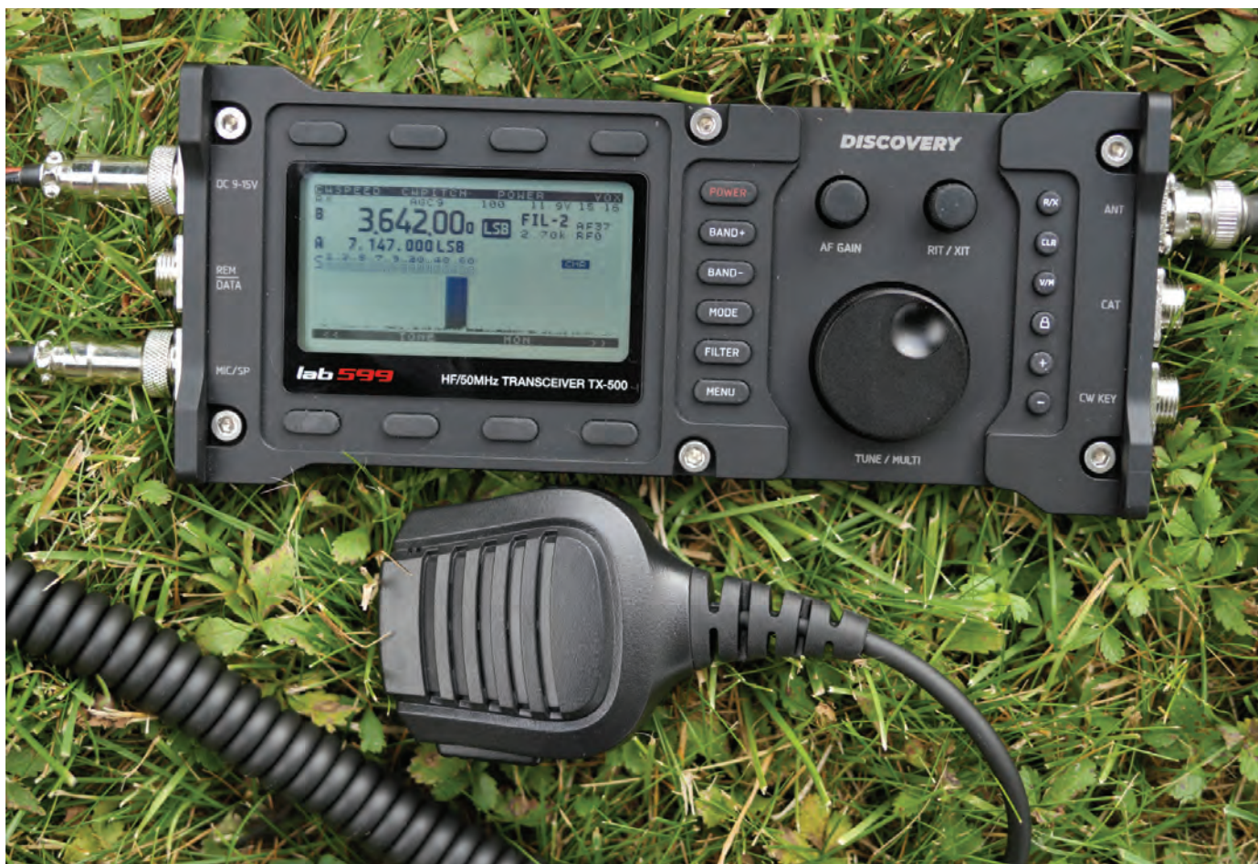
BILD 1: TX-500 i sitt rätta element. Rejåla doningar i lagom format. Alla kontaktorna på sidorna och en skapligt stor frontpanel med gott om plats till knappar och display.
