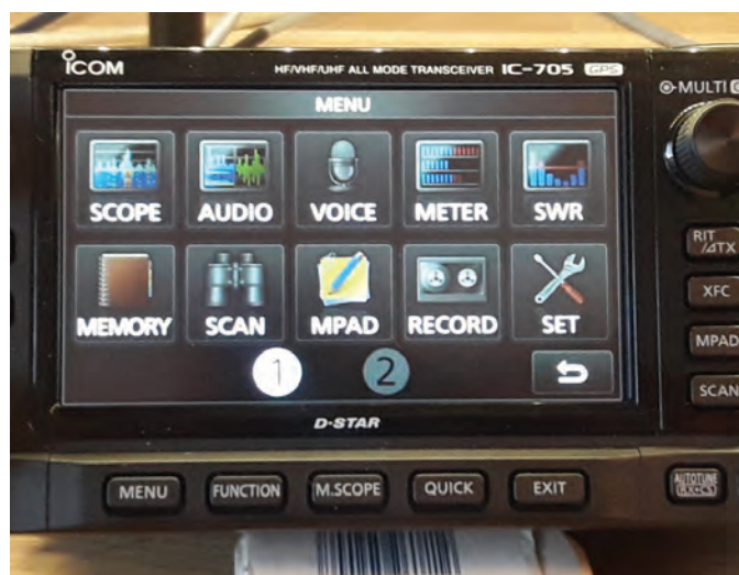
BILD 3: Genom den stora displayen med pekfunktion kan menyhanteringen göras enklare. Gränssnittet känner vana Icom-användare igen från andra modernare apparater.
