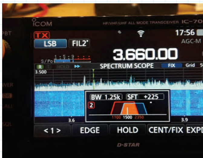
BILD 7: Exempel på hur den grafiska displayen kan användas i IC-705 för att visa inställning av passbandet med Twin Passbandtuning.
