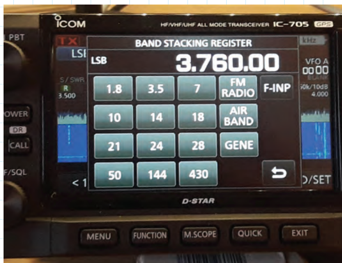
BILD 4: Exempel på intuitiv funktion. Peka på första tecknet i frekvensen och vips kommer bandval upp på skärmen. Peka på trafiksättet och alternativ kan väljas från en meny.
