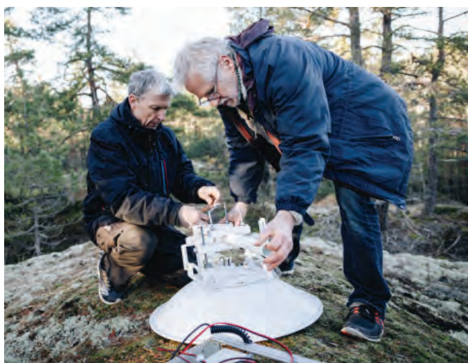
Michael Grimsland och Björn Pehrson riggar i ordning för dagens test. Tanken är att bygga en fast struktur av kommunikationsutrustning ut i skärgården som ska kunna användas i händelse av att ordinarie nät går ner.
