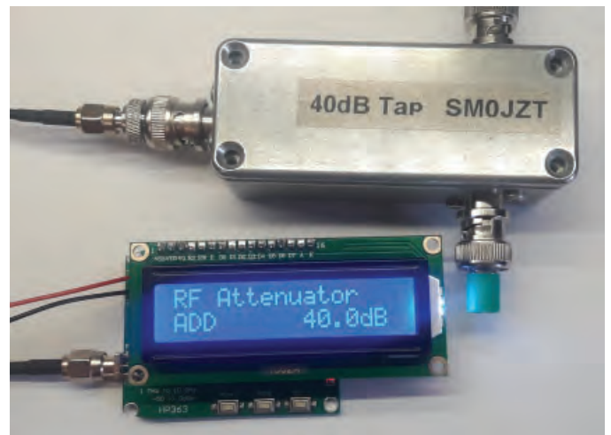
BILD 5: Här ser man modulen i "programmeringsläge". Se i texten kring hur man gör.
