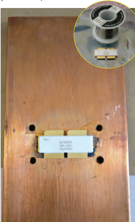
BILD 1: Montering av transistor.
