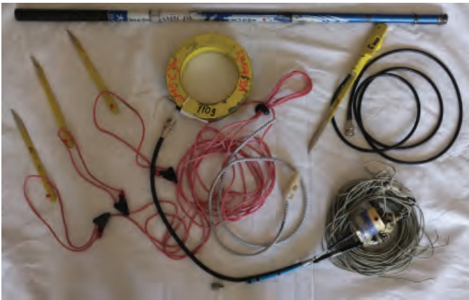
DIVERSE ANTENNmateriel: 4 m kolfiberspö, staglina med tre tältpinnar. EFHW-antenn som är upplindad på bobin för fiskelina. Se vidare i texten.
