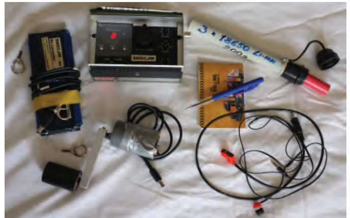
KX1 MED TILLBEHÖR: KX1 som är modifierad för praktisk hantering, solcellpanel, vevgenerator, reservbatterier i behållare (bit av avsågat metspö), loggbok, penna, telegrafnyckel och hörlur.
