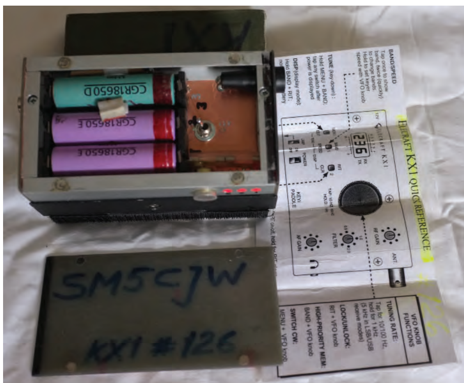
KX1 MED LI-ION-MATNING. Lagg märke till de tre LED (en per cell), voltmetern, magneterna för att hålla locket, omkopplare för inre/ytte matning, säkringshållare, reservsäkringar, tygband för att lyfta batterierna ur sina hållare, manual i kortform.
