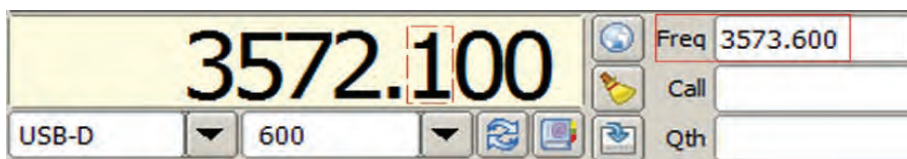
BILD 8: Rig-fönstret med VFO-frekvens, riggens mod och bandpassfilter. Den verkliga signalfrekvensen visas i lilla rutan Freq till höger.
