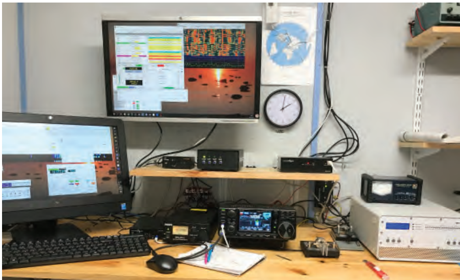
BILD 5: Stationsplatsen - JO97BM Gnisvärd/Gotland - "Burkarna" på hyllan är från vänster Microham CW-Keyer, Rotorkontroll (hembygge), Remoterig Antennswitch, på väggen nedanför: Paradan Antennfrånkopplare. Nedre raden: Remoterig RRC 1258MkII, Nätaggregat, IC7300. Till höger JUMA PA1000.
