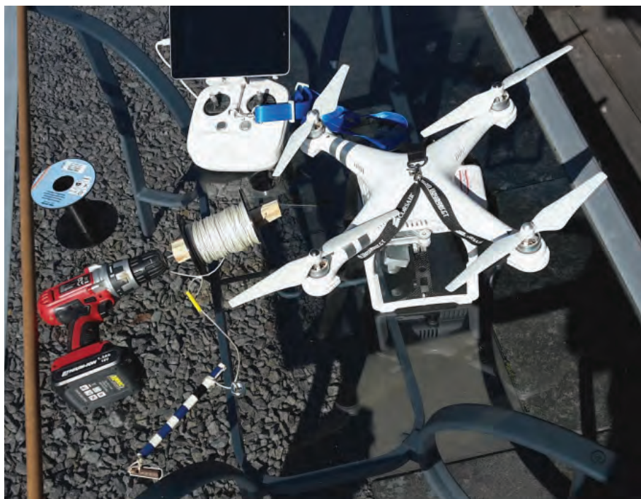
BILD 1: Utrustning för "drönarmetoden" att sätta upp longwire-antennerna. Drönare och fjärrkontroll, lång tunn lina med väl synlig tyngd (randig) i änden och eventuellt en uppvindare för linan. Den långa stören på 4+ m eller båtshaken har man nytta av om en lina fastnat i en gren.
