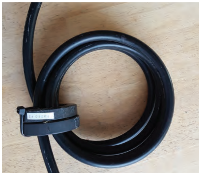
BILD 2: CMC/BALUN med RG213 och 2 st FT 240-43. FT 240-xx rymmer 5 varv med coax kontakt och 6 varv utan. Bäst är att linda på kabeln direkt utan kontakt och ansluta till antennen med att löda direkt i dipoländarna eller med Löd-öron för Yagis.
