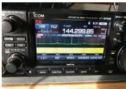
BILD 2: Signallivåer med solcellsanläggning igång. Medelvärde på s-metern är S6.
