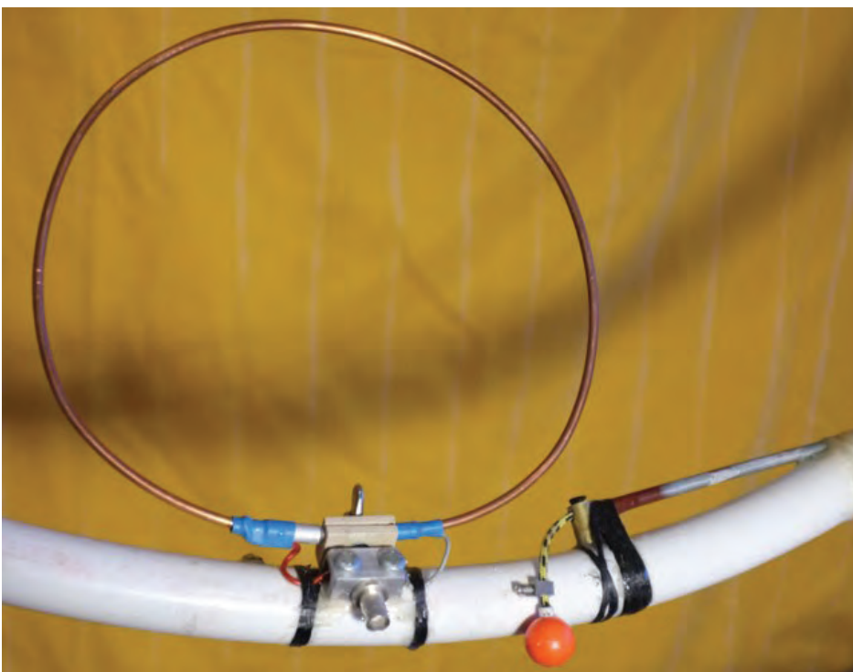
BILD 3: Närbild av matningsloop, D = 23 cm. Genom att vrida matningsloopen in i eller ut ur MLAs magnetfält erhålles lämplig förlustkompensering. Vid den röda plastkulan sitter en "backup"-låsning för avstämningssnöret. Det är en avsågad bit av ett kopplingsstycke från en kopplingsplint. Där är det viktigt med trådskyddsbleck så att inte snöret mosas sönder under skruvänden. Aluminiumprofilen som håller BNC-kontakten är fäst med ett par plåtskruvar. På det viset avleds eventuell statisk elektricitet från huvudloopen. Vid den röda flexibla kabeln kan ett grått plaströr ses. Det håller ihop kopplingsloopens ändrar samtidigt som ändarna isoleras från varandra.
