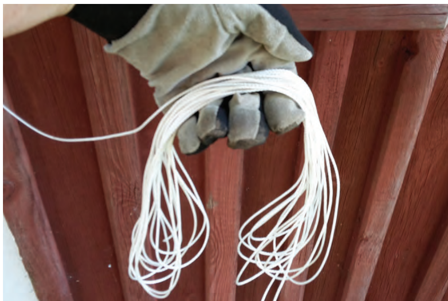
BILD 4: Princip för att vinda upp linor och sladdar för att minska trassel.
