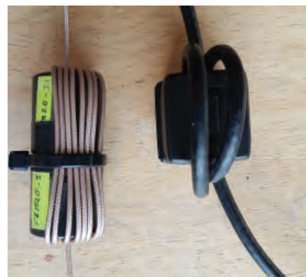
BILD 3: Till vänster CMC för RX antenn, Flera varv på 2 st FB 31-1020 (FB 75- är bättre). Kabel är RG196, RG400 går också bra. Till höger RG58 i klämferrit 2x314181P2.
