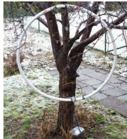
BILD 1: Magnetloopen är här ansluten till WSPR-sändare (i matlådan) och upphängd i trädgården. Många rapporter från bland annat EA8 har noterats.
