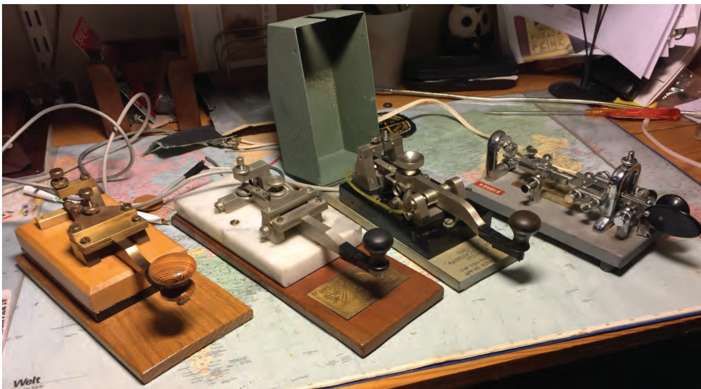
SM6EVE:s nycklar. Från vänster; mässingskopia av Televerkets fartygsradionyckel, autentisk fartygsnyckel à la Televerket, en av försvarets nycklar och Vibroplex Standard.
