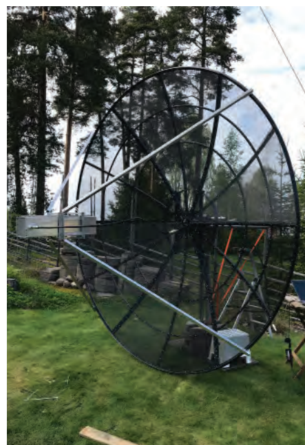
PARABOL PROVISORISKT MONTERAD på torkvindans rör.
