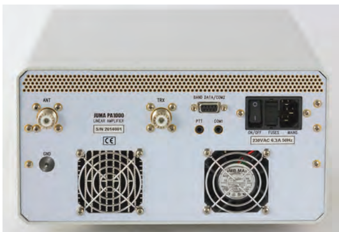
BILD 2: Kontakterna på baksidan av PA1000 ger inga överraskningar. In och ut, spänningsmatning till det inbyggda switchade nätaggregatet och kontakter för att styra PA:t, lokalt och på distans. Väldigt flexibla kontrollmöjligheter.
