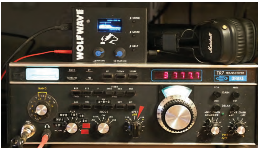
BILD 3: Wolfwave passar bäst till äldre radioapparater som exempelvis en gammal fin DRAKE TR7. Som synes är enheten inkopplad i hörtelefonkontakten till höger om mikrofonkontakten. Hörtelefonen ligger på radion där den är inkopplad i DSP-enheten.
