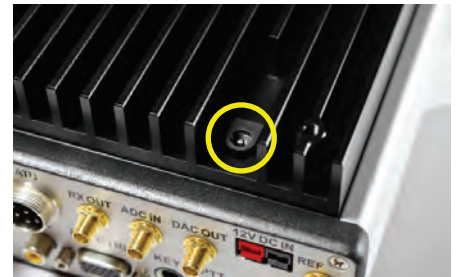
BILD 5: Vid kylflänsen finns en liten kontakt för inkoppling av extern kylfläkt. Det är en mycket bra och viktig finess för att radion skall hålla "huvudet kallt".
