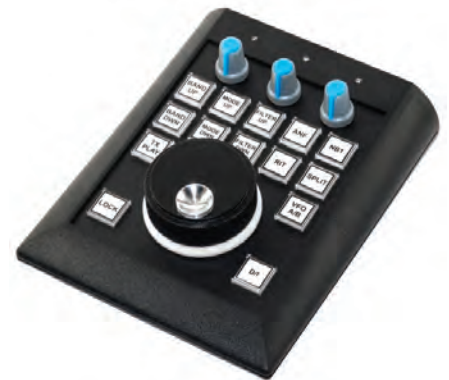
BILD 3: För den som saknar rattar och knappar så kan man koppla en Encoder till datorn. Dom olika knapparnas märkning kan man byta genom att lyfta på "knappen" och lägga in en lapp med annan text.
