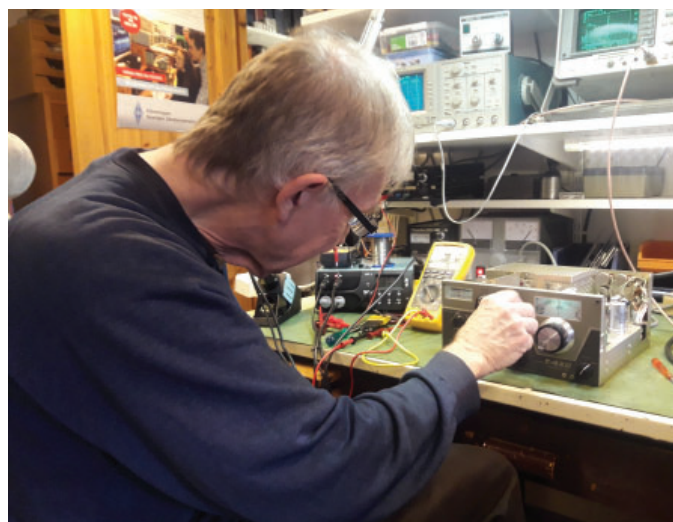
BILD 3: SMOHBV har en särskild känsla för gamla DRAKE-riggjar. Här en C-linesändare som bara ger 50 watt ut, berodde på att elektrolyterna i nätdelen behövde bytas.
