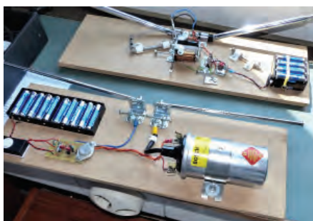
BENGT SM6BLT vid sin demonstrationsanläggning. Gnistsändaren som får högspänning från en tändspole och mottagaren med kohärdetektor av järnfilspån.
