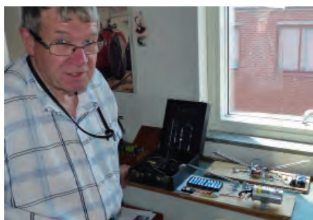
BENGT SM6BLT vid sin demonstrationsanläggning. Gnistsändaren som får högspänning från en tändspole och mottagaren med kohärdetektor av järnfilspån.
