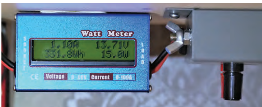
BILD 3: Den använda effektmätaren har här anslutits direkt in till uttagslisten så att den kunde placeras under ett hyllplan i "radiohyllan". Notera att strömmen vid denna bilds tagning är 1,10 A vid 13,71 V. Den totala effektförbrukning har varit 331,8 Wh.
