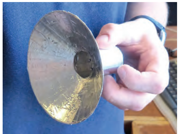
ETT FUNGERANDE BUDGETHORN FÖR 5 GHZ. Kördes fram i labbets nya 3D-printer och kläddes sedan med en metallfolie.
