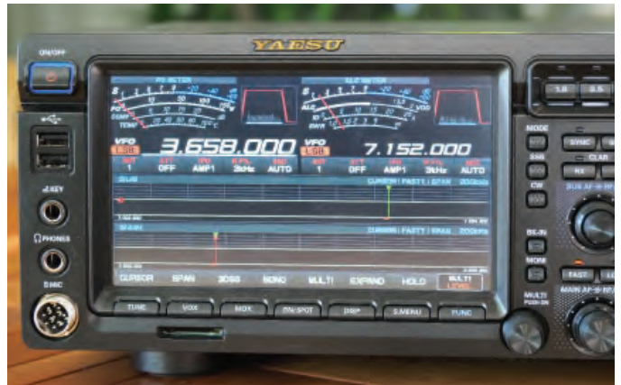
BILD 3. Den stora displayen är förstås ganska dominant på radios frontpanel. Den kan anpassas en del till dom behov och preferenser man kan ha. Några fysiska knappar omgärdar displayen. Till det finns även "knappar" på den tryckkänsliga displayen.
