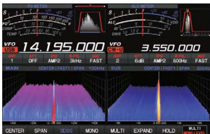
BILD 5. Spektrumvisningen i FTDX-101 kan inte bara visas på traditionellt sätt. I bilden ser man hur visningen sker i tre dimensioner. Här en per band. Ur YAESU-broschyr.
