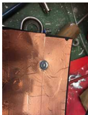
Undersidan av kondensatorn med skruv till kabel.
