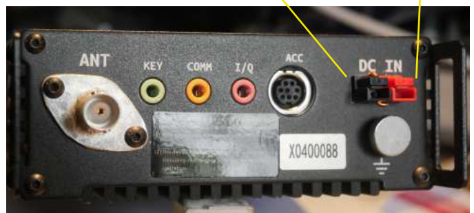
BILD 3: När man sågat och slipat till chassieflänsen för BNC-kontakten och monterat den så ser det riktigt fint ut. Här ser man även hur Anderson Powerpole-kontakten har fallit på plats. Tittar man riktigt noga så ser man koppartråden som läser DC-kontakten så att den inte far in i radion.
