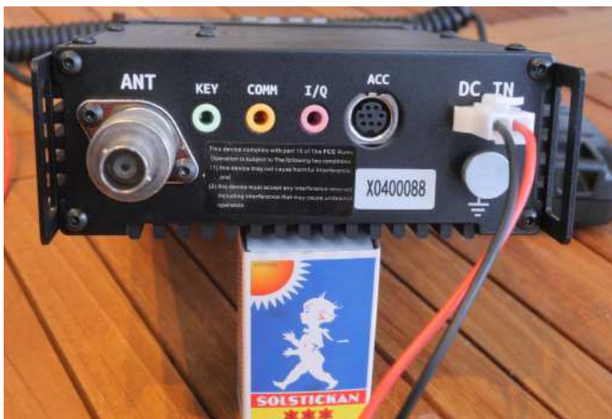
BILD 2: Så här ser radion ut bakifrån i "original" – Här har dock en adapter från UHF-kontakt till BNC satts på plats – i protest.
