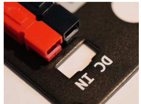
BILD 5: Dags att måtta in powerpole-kontakten, här mot originalhålet. Det är inte mycket metall som skall slipas bort. Var dock noggrann och mät in 15,6 x 7,8 mm. På bilden syns det lilla hålet mellan kontakthylsorna som används för att låsa kontakten så att den inte åker in i radion, se även bild 3.
