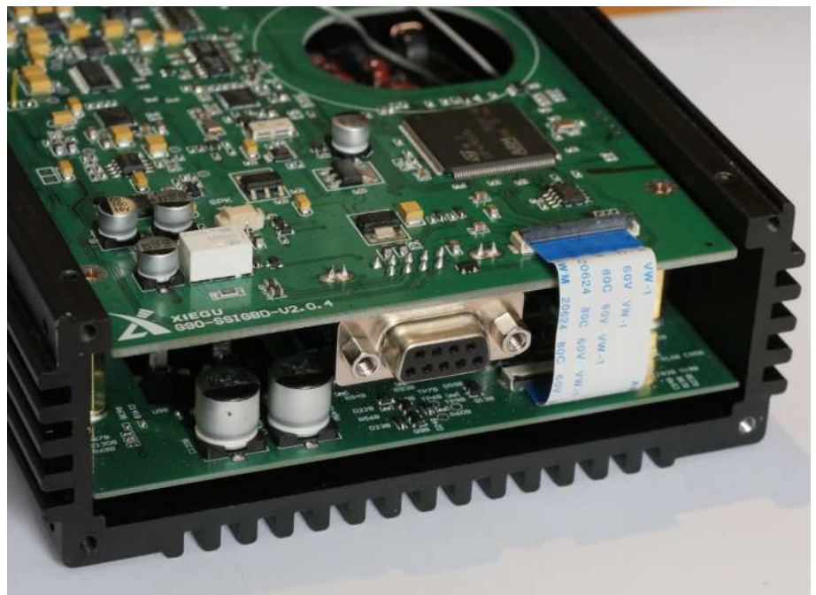
BILD 4. Efter en del skruvande ser man huvudenhetens två kretskort som en dubbelmacka. Bandkabeln lossas genom att man viker upp den svarta delen av kontakten försiktigt.
