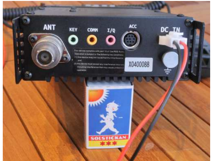
BILD 3. Riggen sedd bakifrån visar upp diverse kontakter. Antennkontakten av typen UHF/SO239 har i protest försetts med en adapter till BNC-kontakt.
