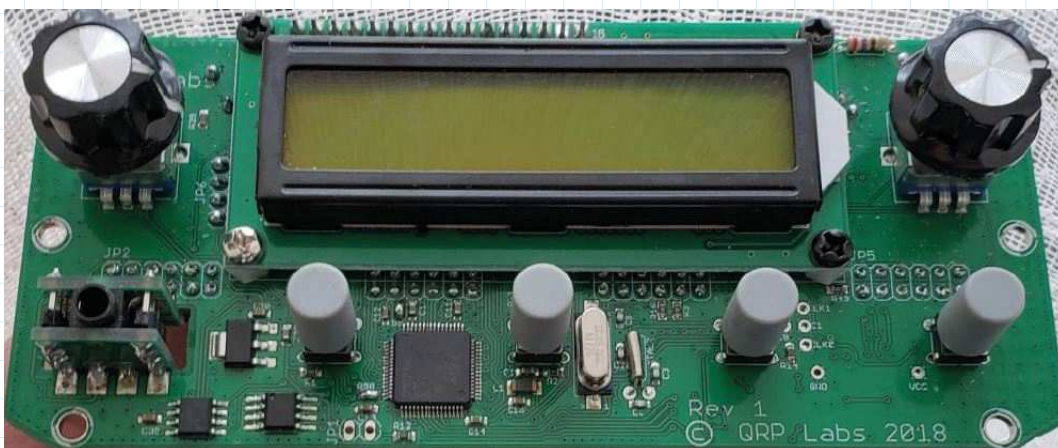
BILD 3: Frontkortet ger inte bara display och "knappologi". Här ser vi tydligt ARM-processorn. Den kommer redan förmonterad för dom som tycker att ytmonterat är bökigt att jobba med.
