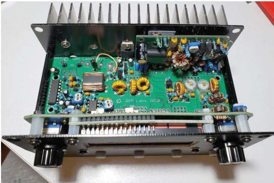
BILD 2: Tittar vi under locket ser vi en radio med städad framtuning. Man ser tydligt att dom analoga delarna har hamnat på kortet i botten och på baksidan. Dom digitala delarna hamnar på frontkortet.
