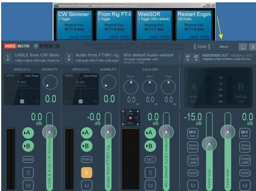
BILD 4. Voicemeeter blir ljudmixer i Windows-datorn och kopplas till exempel så här för att använda Windows ljud och enskilda windowsprogram till FLDIGI.
