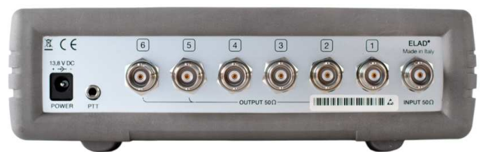
BILD 2 – Där bak på ASA-16 ser man BNC-kontakterna för att koppla enheten till antenn respektive diverse mottagare. En liten 3,5 mm plug används för att kunna aktivera kortslutning av ingången vid sändning (PTT).
