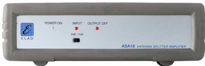
BILD 1 – Inte mycket att orda om. Blå lampa visa att enheten är på. Med en liten omkopplare på fronten kan man koppla in en dämpsats om 15 dB på ingången.
