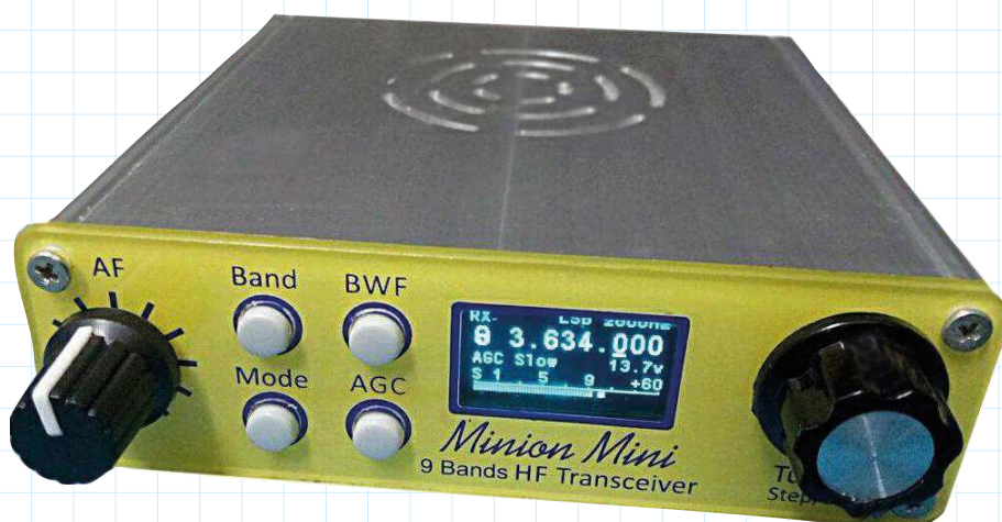
BILD 1 - RADION HETER MINION MINI enligt frontpanelen. Kommer från Ukrainska QRPver och är pytteliten med sina blygsamma mått av 103 x 100 x 34 millimeter.
