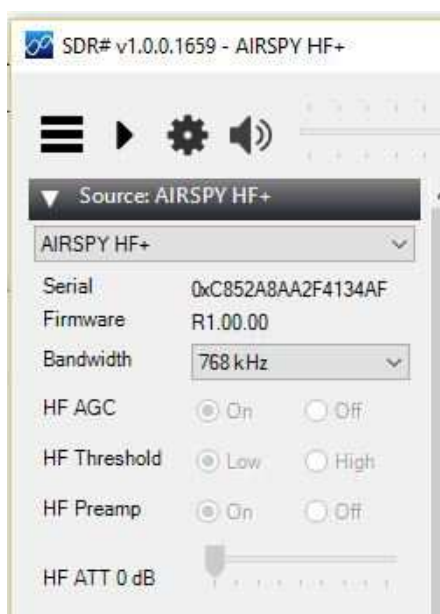
BILD 6. Här ser man att den inkopplade mottagaren har version 1.0.0 av firmware, behöver uppdateras alltså.
