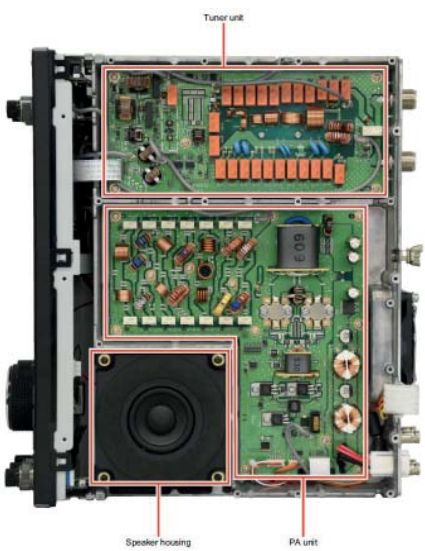
BILD 6 , ovasidan på radion under huven visar uteslutande analoga delar. Överst antennenpassaren därunder slutsteg (100 W) och dom därtillhörande lågpasfilterna. Högtalaren gör ett ok jobb. Externa lurar eller stereohögtalare är mycket bättre.
