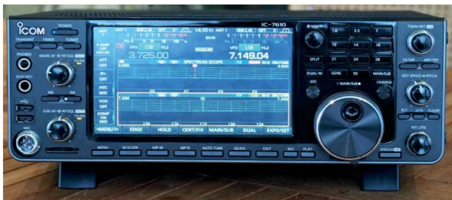
BILD 4 , IC-7610 ser ut som vilken ICOM-radio som helst. En hel del knappar och rattar och för all del en skapligt stor skärm. En utmärkt integrerad SDRadio.
