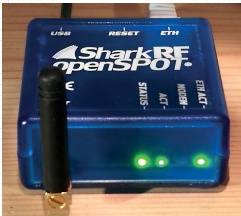
Bild 2 - Openspot från SharkRF är en liten enhet med allt inkluderat. Den lilla antennen och blott 20 mW uteffekt ger inte någon stor räckvidd, men det är inte meningen med en hotspot.
