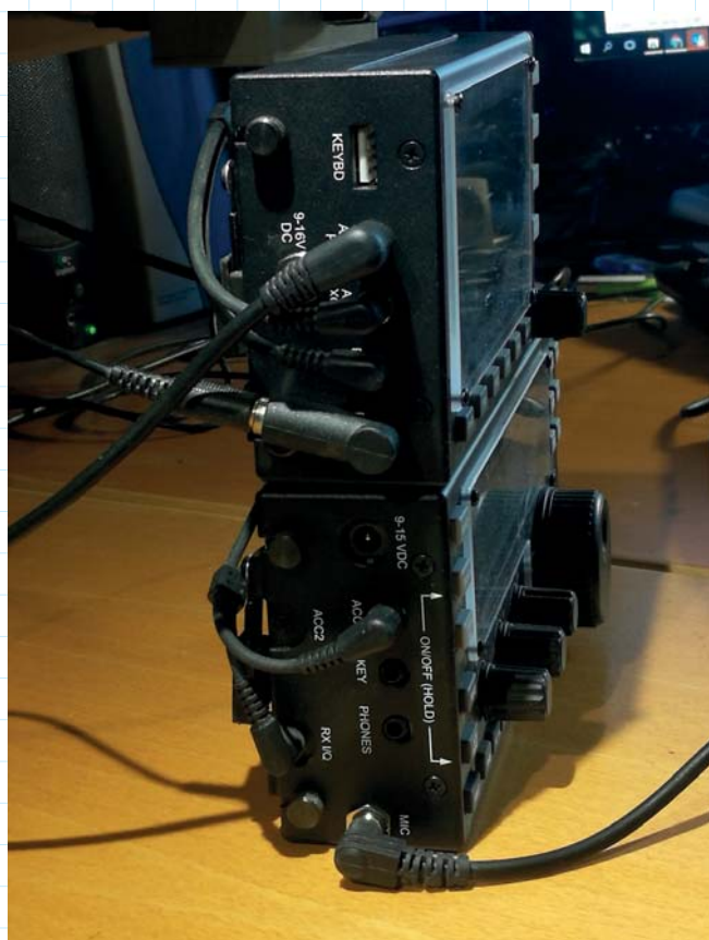
BILD 2: Det ser ut som ett gytter av kablar, sanningen är att allt som behövs för att PX3 och KX3 skall kunna prata med varandra är två kablar. De andra kablarna är för extern kommunikation, mikrofon, telegrafnyckel och för all del spänningsmatning. Högst upp skimtar en USB-kontakt för att koppla in ett PC-tangentbord.
