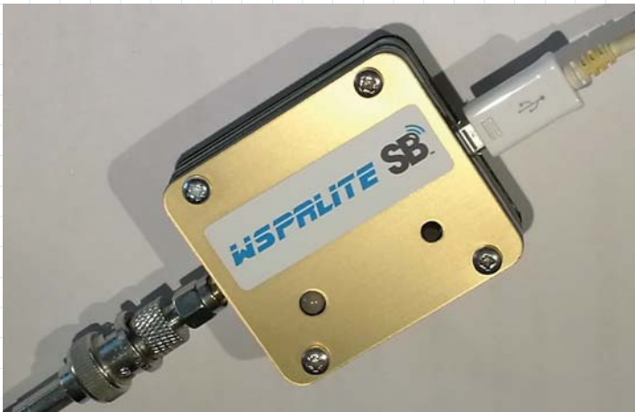
Bild 1. Som framgår av bilden är enheten liten. SMA-kontakt för anslutning till antenn, här via adapter till BNC och 30-metersdipolen på vinden.
