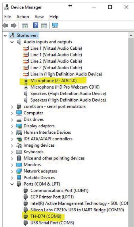
BILD 4 DEVICE MANAGER: När man kopplar radion till datorn dyker det upp lite nya virtuella resurser till förfogande. Här gulmarkerat en "microphone (2-ADC)" för ljudström och COM8 för styrning som virtuell serieport. I Windows 10 dyker dom upp automatiskt.
