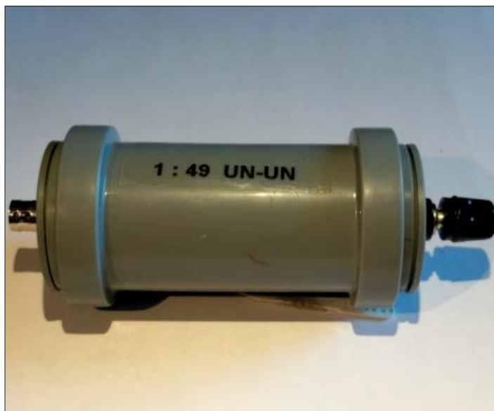
Bild 9 – Här unun-en enligt SMOJZT klar att tas i bruk. Toroiden är instoppad i en avloppsmuff med lock med diametern 40 mm. BNC-kontakt i ena ändan och polskruv i andra.
