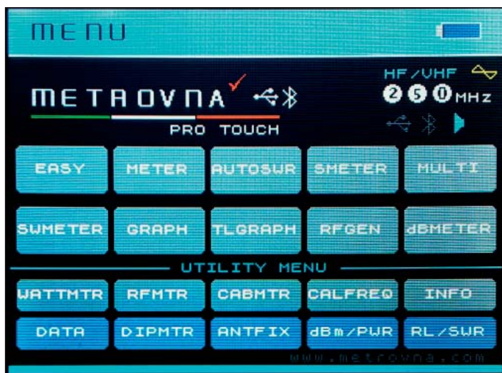
Bild 3 – Huvudbilden på den grafiska displayen. Som framgår av texten består menyöverblickens av två delar. Den övre för antennanalys (user menu) och den undre för diverse nyttigheter i labbet.
