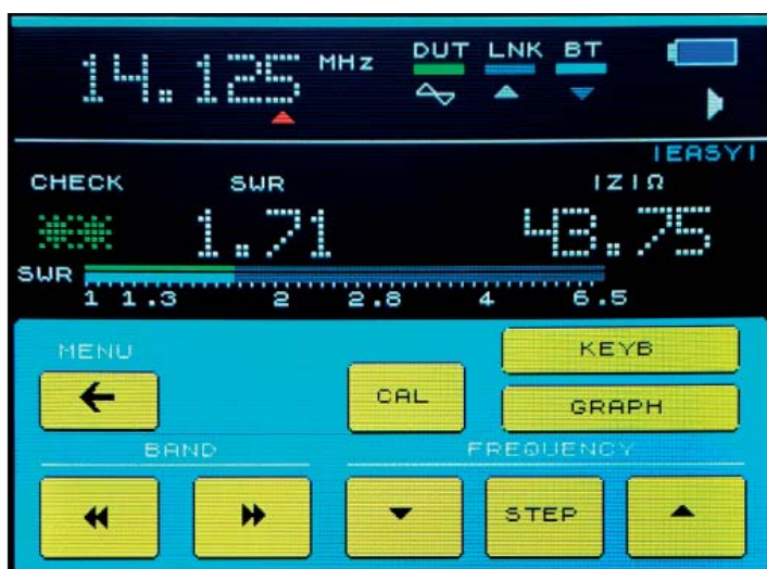
Bild 4 – EASY-menyn en snabb överblick för antennmätningar. Här ser vi att antensystemet ger en SWR av 1,71 och en impedans av 43,75 ohm. Man kan snabbt byta band eller stega upp och ner i frekvens. Vill man se resultatet i en graf finns en knapp för det.
