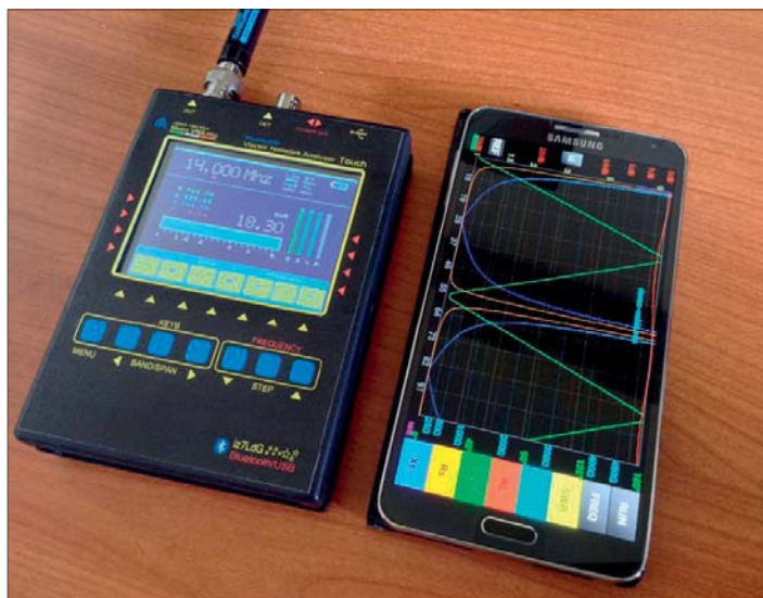
Bild 1 – MetroVNA finns i flera utföranden. Ta Deluxversionen som klarar 1–250 MHz. Här ligger en Androidtelefon vid sidan som tar upp information via blåband.
