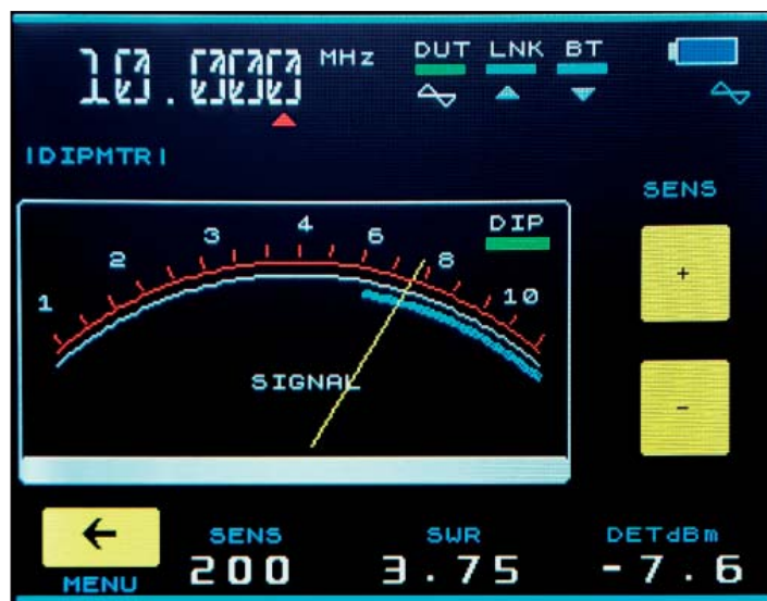
Bild 7 – En griddippa behöver alla. Tryck på menyvalet "DIPMTR" så finns den där med ett analogt instrument som hjälp för att finna "dippen".
